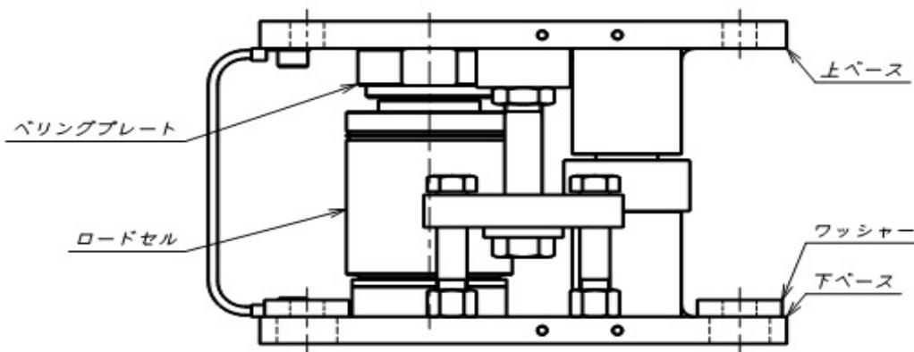
●フレキシブルストップ方式振れ止め機構付取付金具 FCA-CC010-※
